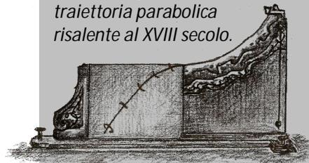
**Un oggetto lanciato da un trampolino descrive una traiettoria parabolica, composta da un movimento con velocità costante in orizzontale ed uno accelerato in**
